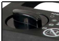
**5.4.** Тепловая пушка включается, когда переключатель установлен на один из режимов работы двигателя.
